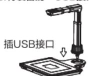
Step4.上推“螺纹固定件”,将“铝管固定件”插入文稿台
